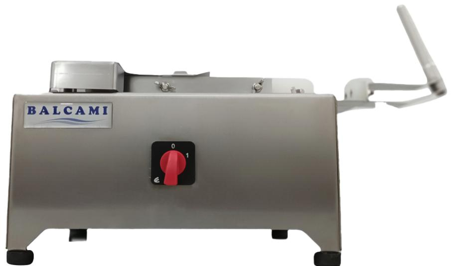
La Fileteadora-250 es una máquina diseñada para filetear uniformemente hasta 250 kg de carne por hora. Su principal beneficio es la máxima velocidad de producción que permite y la constancia en el corte.
